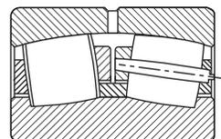
Fig. 10. Pin-type cage.
