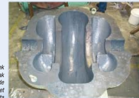
Lofite® Nordbak® 7227 Kwastbare Keramiek Grijs aangebracht om het gestraalde oppervlak te beschermen tegen corrosie. Vul de gecorrodeerde en uitgesleten zones met Lofite® 7222 Slijtvaste Pasta
