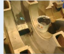
Afb. 3: Applicatie van Loctite® Nordbak® 7227 op behuizing en stroomzone
