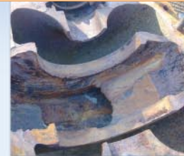
Afb. 1: Corrosie en erosie waren overduidelijk
