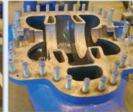
Afb. 4: Volledige oppervlak wordt gecoat, na gedeeltelijke uitharding wordt een tweede laag aangebracht
