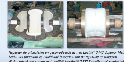
Bovenste sluiting en bronzen waaier voor reparatie. De eerste stap is om deze onderdelen abrasief te stralen tot SA-3 blank gestraald met 75 µm profiel
