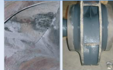
Waaier en behuizing voor reparatie. Ernstige slijtage en cavitatie op de waaier
