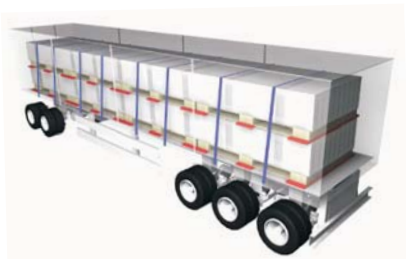
Neersjorren m.b.v. anti-slipmatten
