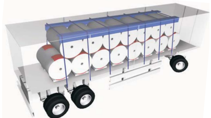
Neersjorren m.b.v. anti-slijpmatten (rood) en hoekbeschermers (blauw)
