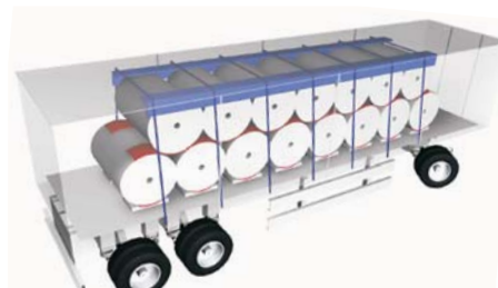
Neersjorren m.b.v. anti-slipmatten (rood) en hoekbeschermers (blauw).
